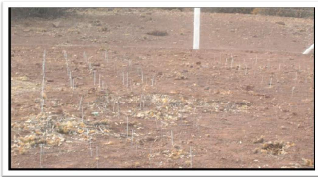
Figura 17. Parcela experimental de clavos de erosión
