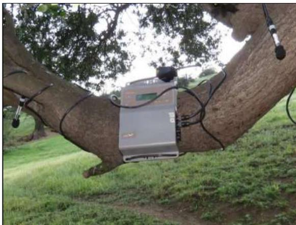
Para complementar el uso del songmeter, se realizó una prospección nocturna, en la que se realizó búsqueda de individuos por medio de un equipo detector de ultrasonido “batscan”, modelo Pettersson D240x. Este equipo, permite una rápida evaluación sobre la presencia de estos mamíferos en las áreas prospectadas y el registro de las emisiones de los quirópteros en una grabadora de alta definición conectada al equipo de ultrasonido.
