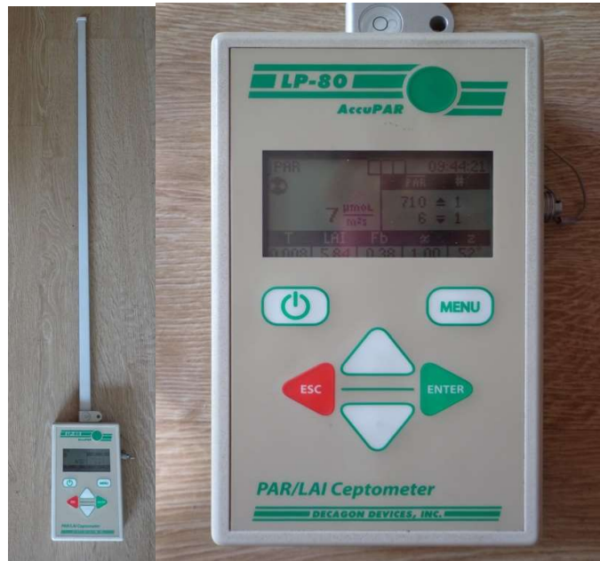
Figura 25. Ceptómetro Decagon AccuPar LP-80 utilizado para la medición del Índice de Área Foliar. Fuente: Autoría propia.
